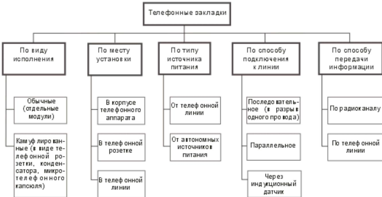
Рисунок 2 - Классификация телефонных закладок
