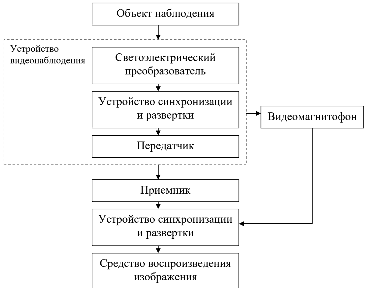
Рис. 4.5. Схема средств телевизионного наблюдения [7]
